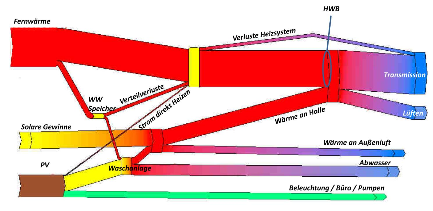
Energieflussdiagramm der ÖKO-Service. Der im Jahr 2017 von der **PV-Anlage am Dach** ins Netz eingespeiste Strom deckt in etwa den Stromverbrauch der ÖKO-Service Halle.
