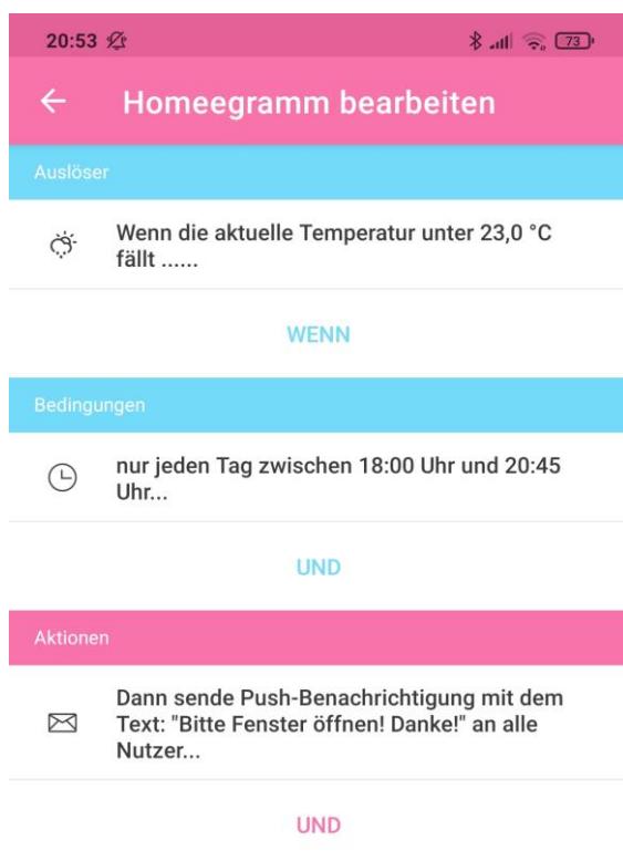
Abbildung 27: Einstellung der Push-Nachricht zum Öffnen der Fenster via homee
