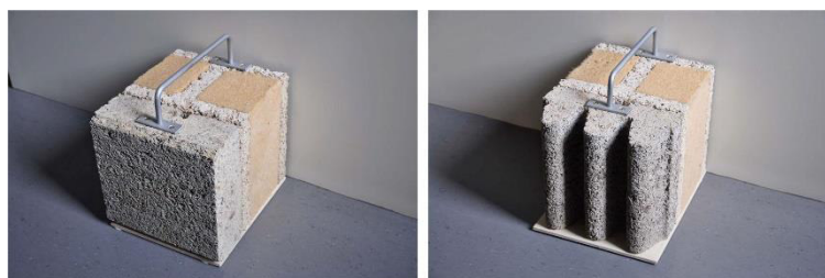
Abbildung 4: Miniprototypen Multifunktionsfassade (links: flacher Absorber, rechts: gewellter Absorber)
