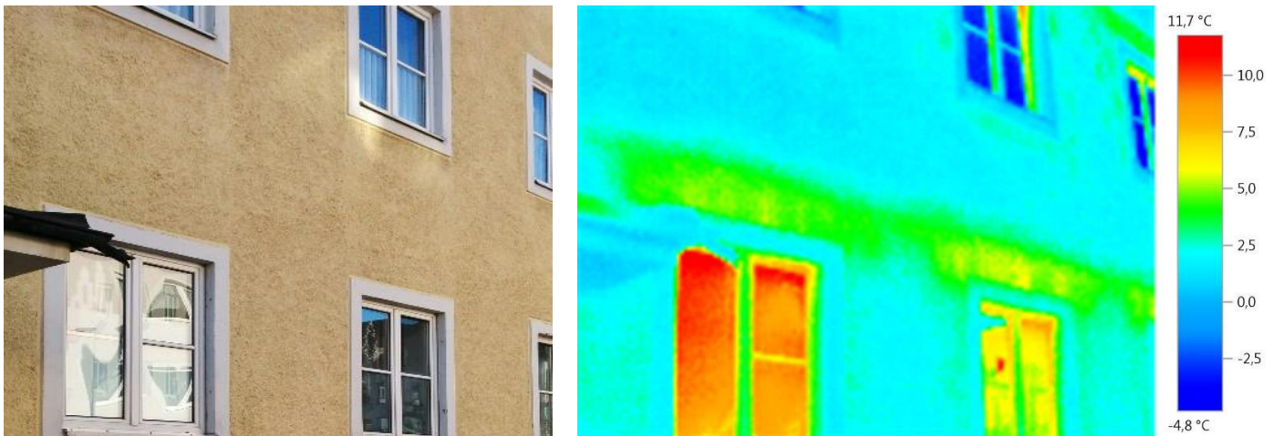
Abbildung 16: Gegenüberstellung Fotografie/Thermographische Aufnahme Döttlstraße 5-7
