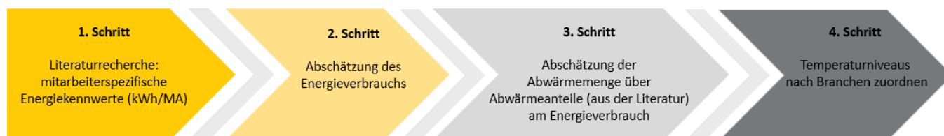
Abbildung 2: Schritte zur Abschätzung des Abwärmepotenzials (Quelle: AIT)
