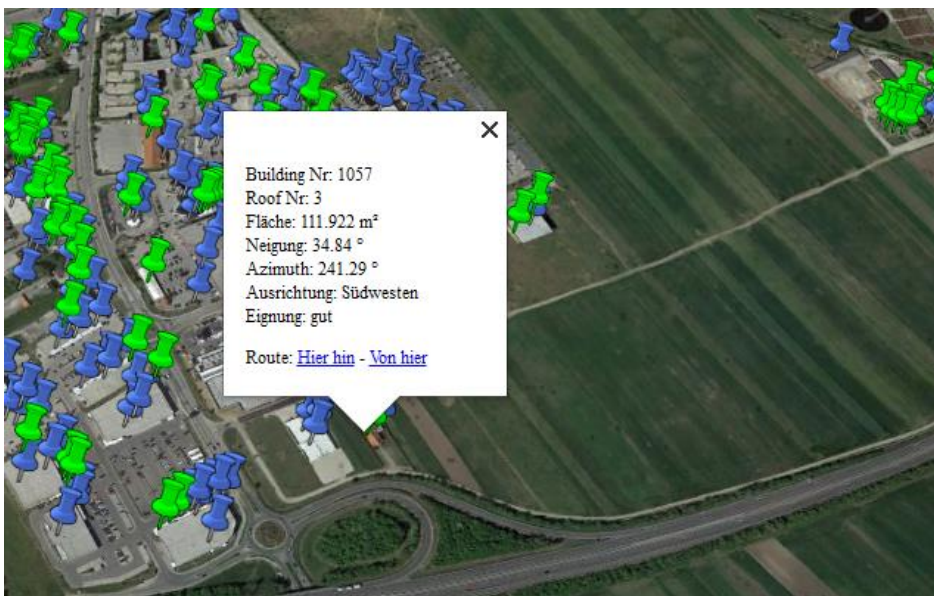
Abbildung 3-8: Beispielhafte Darstellung einer PV-Fläche in Google Earth
