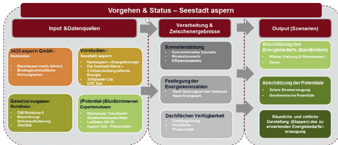
Abbildung 13 Vorgehensweise Energiebedarfsabschätzung aspern Seestadt
